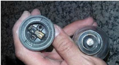
Figura 6. Contacto eléctrico de un portalámparas deteriorado.
