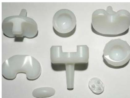
Figura 6. Elementos de prótesis en UHMWPE.
