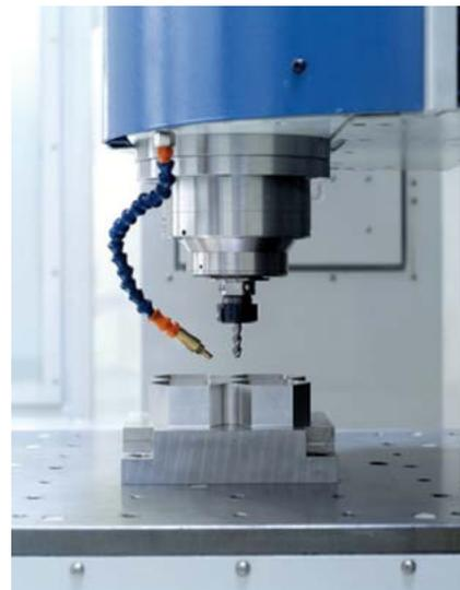
Cabezal de una máquina herramienta. Foto: IK4-Tekniker.
